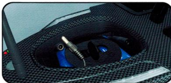
Подключите аккумулятор Подключите интерфейс батарейного отсека к аккумулятору при дальнейшем использовании кораблика
