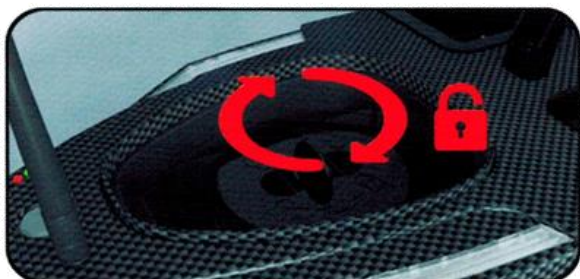
Извлечение аккумулятора и установка Поверните заглушку по часовой стрелке, чтобы открыть и извлечь аккумулятор. Вставьте заглушку на место и поверните против часовой стрелки, чтобы закрепить.
