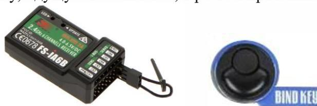
3.2. Подайте питание на приемник, например через регулятор скорости, в любой из свободных каналов приемника (5 Вольт). Если приемник подключен к автопилоту, то просто включите кораблик. Светодиод на приемнике будет мигать красным цветом.
