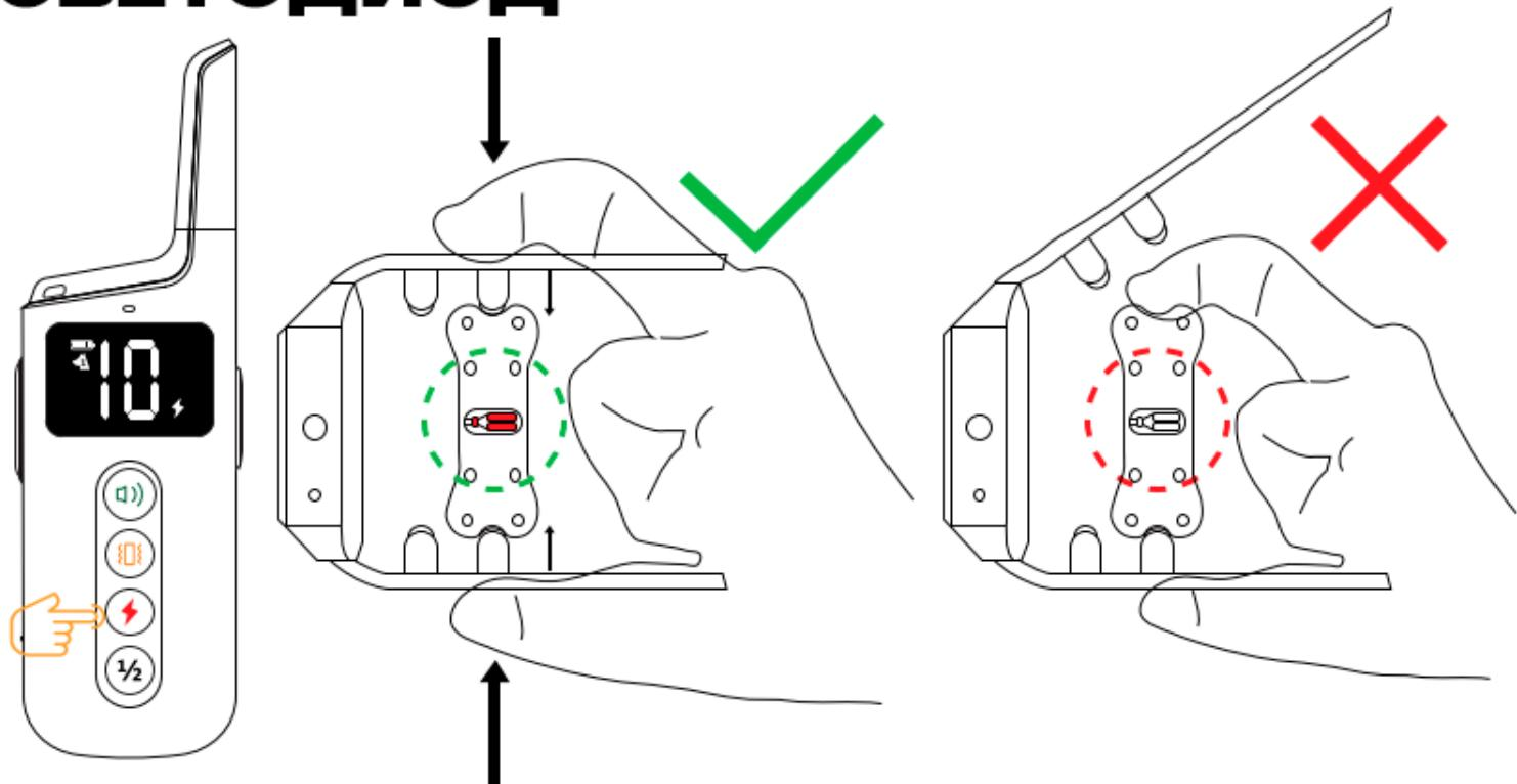
Убедитесь, что ошейник подключен к передатчику и приемнику . Пожалуйста, включите функцию статической стимуляции и установите уровень на 10. Поместите контрольный индикатор между двумя контактными точками и убедитесь, что его интерфейс соприкасается с контактными точками. Нажмите кнопку статической стимуляции еще раз, если контрольный индикатор горит , что означает, что статическая стимуляция работает.
