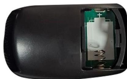
Установите крышку батарейного отсека на место (до характерного щелчка).
