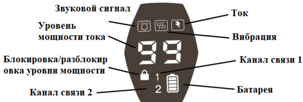
**Светодиодный дисплей:** отображает режим удара током, звуковой сигнал или вибрацию; отображает уровень удара током, уровень блокировки/разблокировки, идентификатор собаки, уровень заряда батареи.
