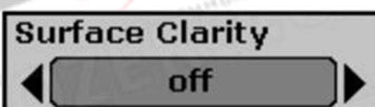
Настройки: «Выкл.», «Высокая», «Средняя», «Низкая». Чистота поверхности настраивает фильтр, удаляющий помехи от поверхности, вызванные водорослями и аэрацией. Чем ниже значение параметра, тем больше помех от поверхности будет отображаться.
