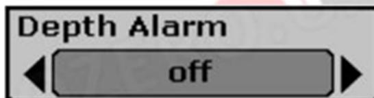
Настройки: «Выкл.», от «1 фута» до «99 футов» («от 1 м» до «30 м»). Сигналы глубины издают звуковой сигнал, а индикатор сигнала глубины начинает мигать, когда сигнал о глубине становится меньше, чем установлено значение сигнала тревоги глубины.
