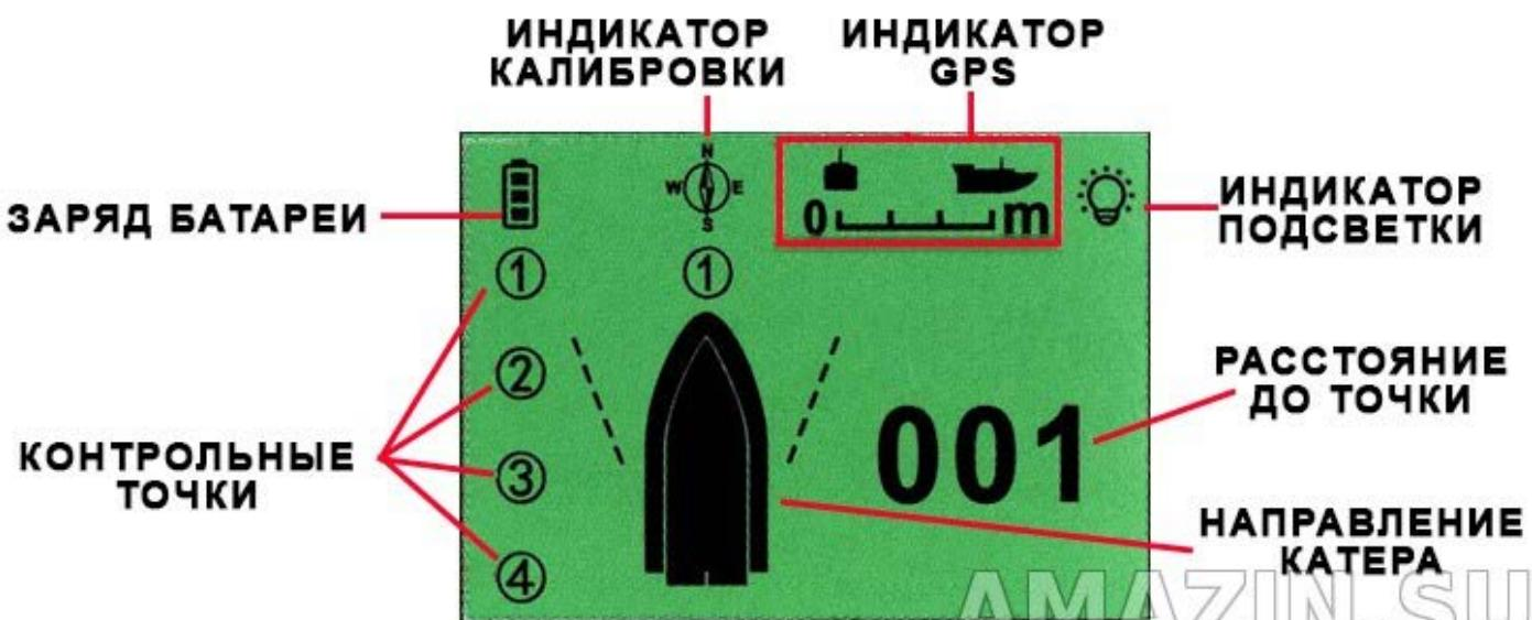
**1. Значок заряда батареи кораблика:** отображает мощность заряда батареи кораблика.
