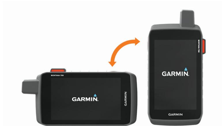
**ПРИМЕЧАНИЕ.** при использовании функций inReach устройства Montana 700i/750i необходимо использовать устройство в вертикальном (книжном) режиме, чтобы антенна была направлена в сторону неба.
